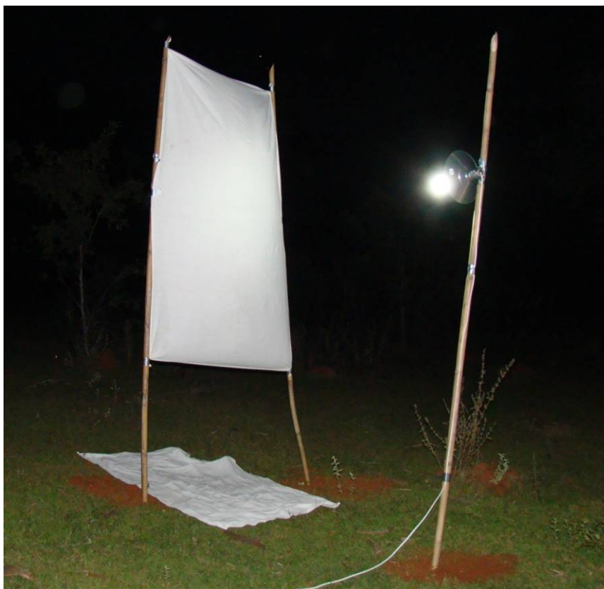
Figura 11 – Armadilha luminosa para atração de triatomíneos
